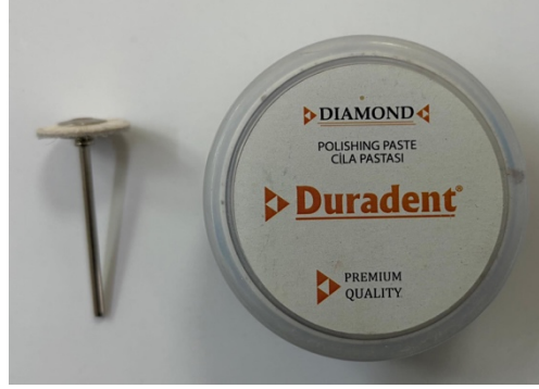
Resim 5. Çalışmada kullanılan polisaj fırçası ve patı
