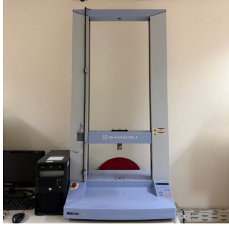
Resim 13. Çalışmada kullanılan universal kırma cihazı
